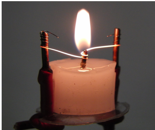
Fig. 6. Una vela con mecha metálica artificialmente calentada usando corriente eléctrica.
